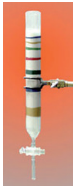
Figura 2.3. Cromatografía en columna: separación de pigmentos.
