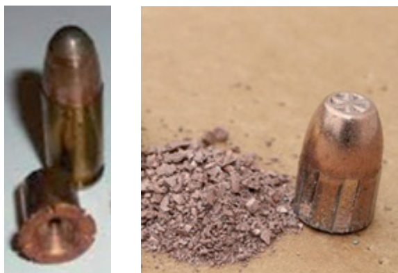
FIGURA 6.7. Balas expansivas y balas frangibles. Aspecto, de ambas una vez que impactan.
