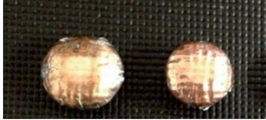
FIGURA 6.8. Marcas del impacto con un chaleco antibalas.
